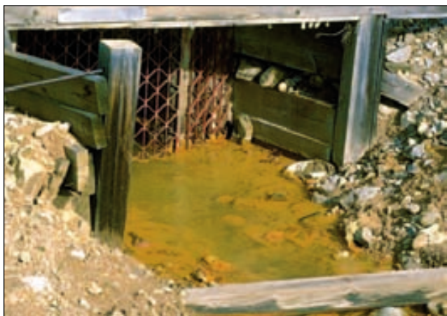
▲ Figura 6.5 Esta agua que va penetrando desde una mina abandonada en Colorado es un ejemplo de drenaje ácido de mina . El drenaje ácido de mina es agua con una gran concentración de ácido sulfúrico ( \text{H}_2\text{SO}_4 ) producida por la oxidación de los sulfuros como la pirita. Cuando esta agua rica en ácido migra desde su origen puede contaminar las aguas superficiales y las subterráneas y provocar daños ecológicos importantes. (Foto de Tim Haske/Profiles West/Index Stock Photography, Inc.)
