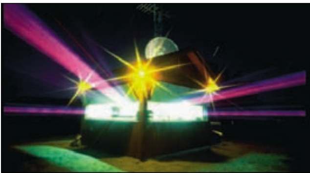
▲ Figura 11.21 Láser utilizados para medir el movimiento a lo largo de la falla de San Andrés. (Foto de John K. Nakata/U. S. Geological Survey.)
