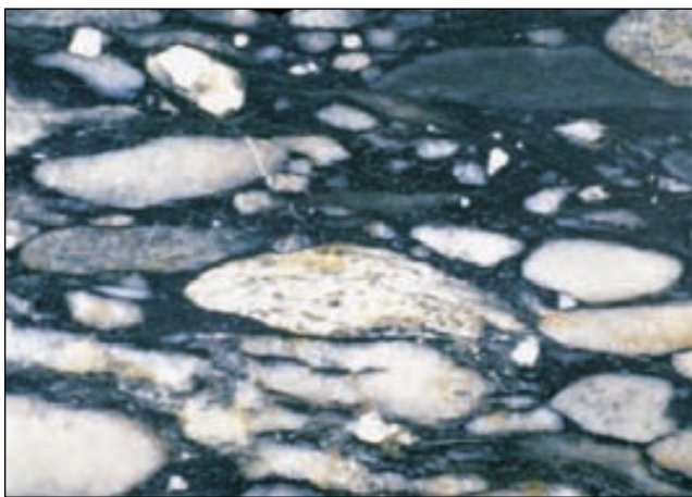
▲ Figura 8.3 Metaconglomerado, también llamado conglomerado de cantos estrados. Estos cantos, que antes eran casi esféricos, se han calentado y se han aplanado hasta convertirse en estructuras alargadas. (Foto de E. J. Tarbuck.)
