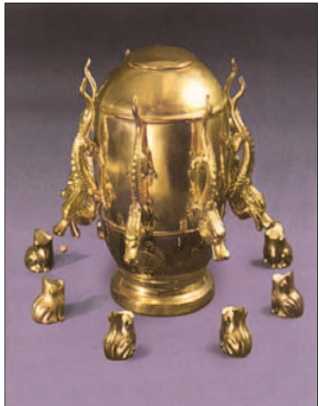
▲ Figura 11.5 Antiguo sismógrafo chino. Durante un temblor de tierra, los dragones situados en la dirección de las vibraciones principales tiraban una bola en las bocas de las ranas de debajo.
