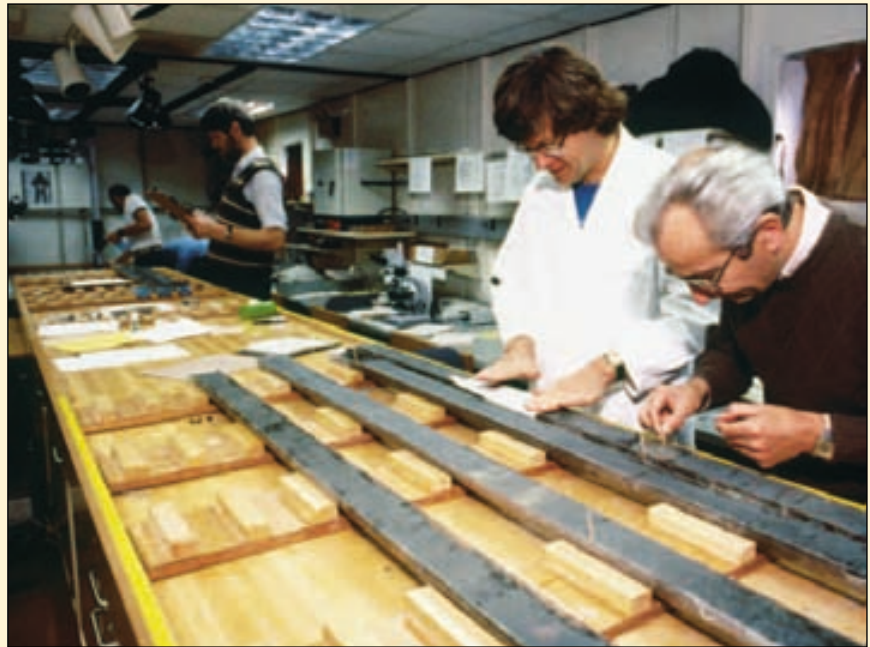
▲ Figura 7.D Los científicos examinan el testigo de sondeo de un sedimento a bordo del JOIDES Resolution , el buque de perforación del Ocean Drilling Program. El fondo oceánico representa una enorme reserva de datos referentes al cambio ambiental global. (Foto cortesía del Ocean Drilling Program.)
