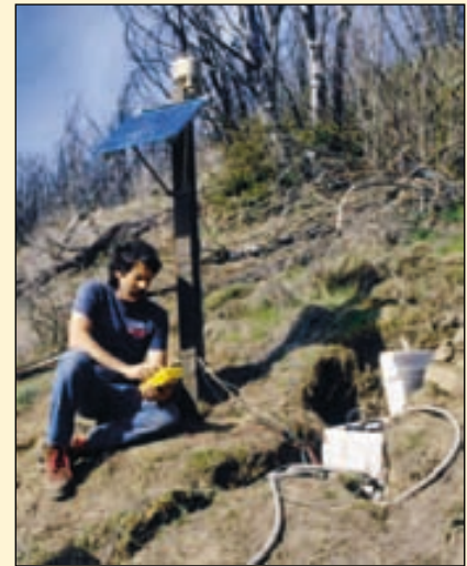
▲ Figura 15.C Prueba de un sistema de radioteleetría alimentado con energía solar para la transmisión a distancia de datos de un deslizamiento en tiempo real. En las zonas de deslizamiento controladas a distancia, el movimiento del suelo y las presiones de las aguas subterráneas se miden cada segundo. La cantidad del movimiento descendente es registrada por extensómetros que pueden detectar la tensión o el acortamiento del suelo. Las vibraciones del suelo se controlan mediante geófonos enterrados en el interior de los deslizamientos. Las condiciones de las aguas subterráneas en el interior de los deslizamientos se controlan a través de sensores de la presión del agua de los poros y los pluviómetros in situ registran las precipitaciones. (Foto de Mark Reid/U. S. Geological Survey.)
