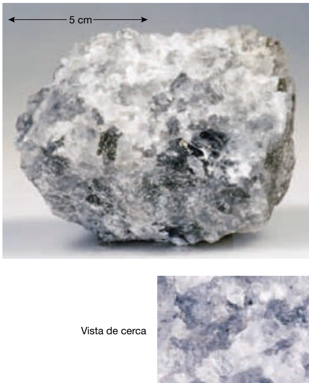
▲ Figura 7.8 Como otras evaporitas, esta muestra de salgema se dice que tiene una textura no clásica porque está compuesta de un intercrecimiento de cristales.
