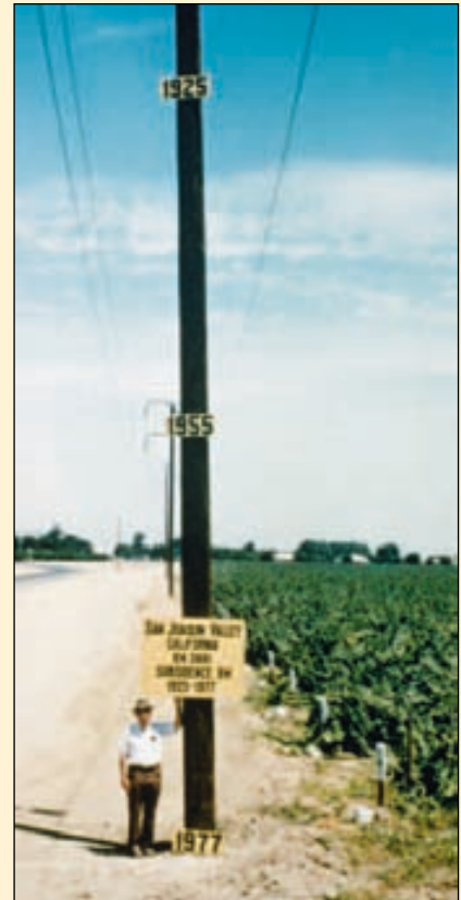
▲ Figure 17.D Las marcas de este poste de luz indican el nivel de la tierra circundante en los años anteriores. Entre 1925 y 1975 esta parte del Valle de San Joaquín experimentó una subsidencia de casi 9 metros como consecuencia de la extracción de agua subterránea y la compactación consecutiva de los sedimentos. (Foto cortesía de U.S. Geological Survey.)
