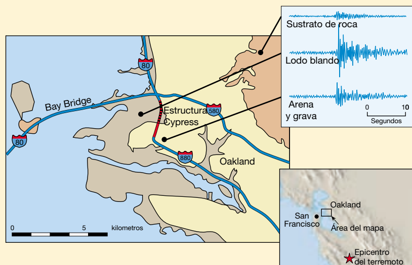
▲ Figura 11.B La porción de la estructura de la autopista Cypress, en Oakland, California, que se construyó sobre el lodo blando (línea roja punteada) se hundió durante el terremoto de Loma Prieta, 1989. Las partes adyacentes de la estructura (rojo sólido), que se construyeron sobre terrenos más firmes, permanecieron de pie. Los sismogramas de una réplica (arriba a la derecha) muestran que la vibración se amplifica mucho en el lodo blando, en comparación con los materiales más firmes.
