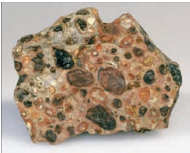
▲ Figura 21.20 La bauxita es la mena de aluminio y se forma como consecuencia de procesos de meteorización bajo condiciones tropicales. Su color oscila entre el rojo o el marrón y el casi blanco. (Foto de E. J. Tarbuck.)
