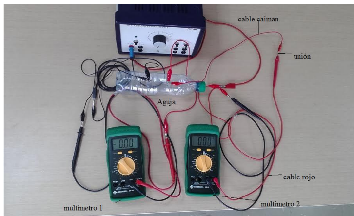
Foto 6 Conexión del multímetro 2 al sistema (botella-conexiones)
