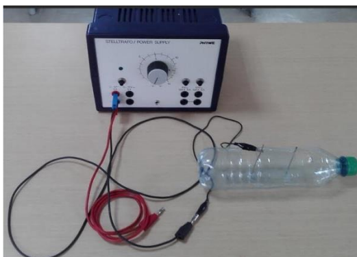
Foto 3 cable positivo de la fuente unido a la conexión de cobre
