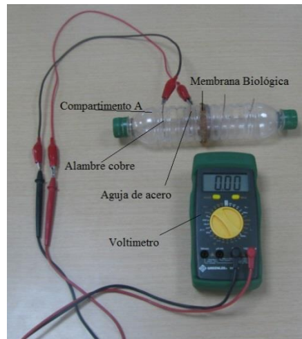
Foto 6 multímetro conectado al compartimento A
