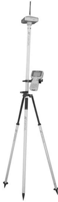
Figura 3-10. Instalación de la Estación Rover
