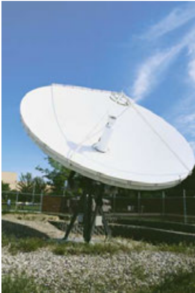
Una antena de disco refleja señales satelitales al foco de un paraboloide.
