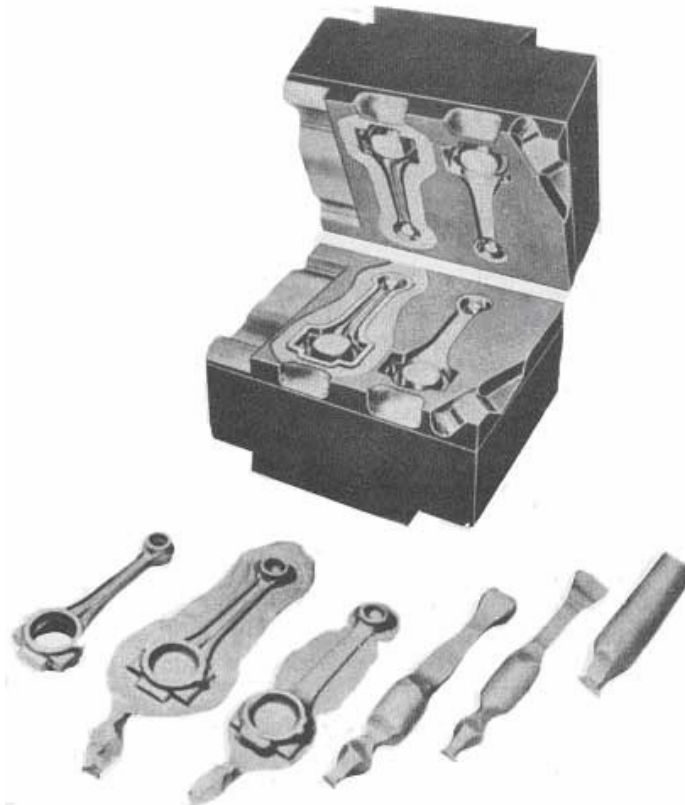
FIGURA 3.20 Secuencia en el forjado con dado impresor: (1) inmediatamente antes del contacto inicial con la pieza de trabajo en bruto, (2) compresión parcial, (3) cerradura final de los dados, ocasionando la formación de rebaba entre las placas del dado y (4) muestra una secuencia de pasos en la fabricación de una biela así como el dado
