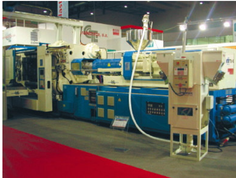
FIGURA 2.43 Una máquina de moldeo por inyección con 3000 ton de capacidad (cortesía de Cincinatti Milacron).
