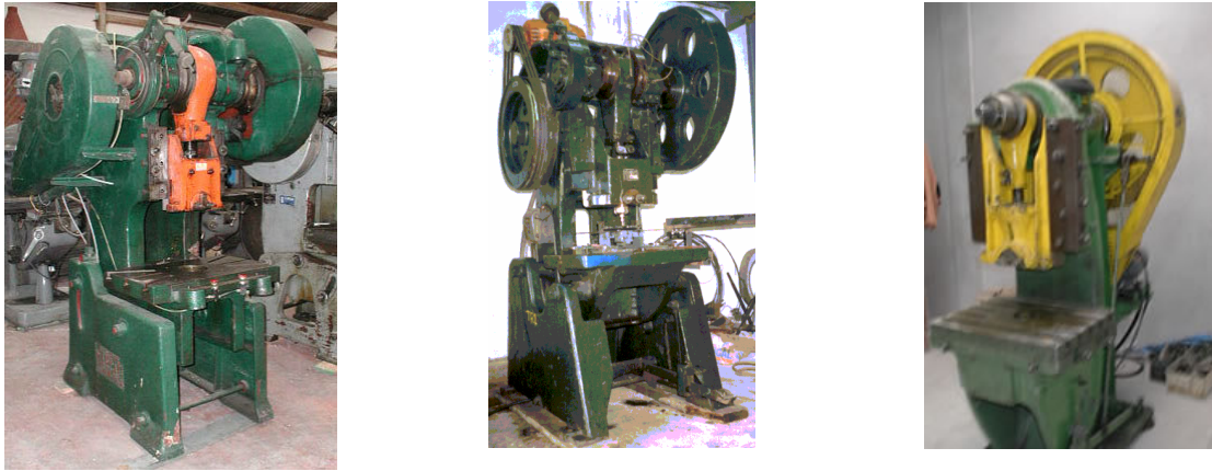
FIGURA 3.84 Tipos de transmisión para prensas destinadas al trabajo de metal en lámina: (a) excéntrica, (b) de manivela y (c) de junta de bisagra.
