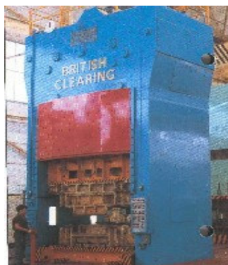
FIGURA 3.83 Prensa con armazón de lados rectos (cortesía de Greenered Press & Machine Company, Inc.).
