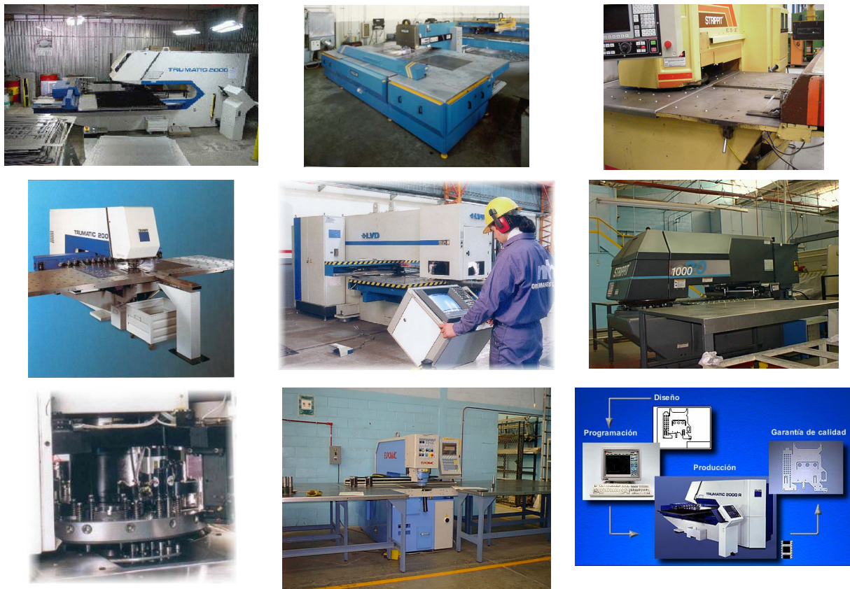
FIGURA 3.82 Prensas de torreta de control numérico computarizado (cortesía de Strippet, Inc.).
