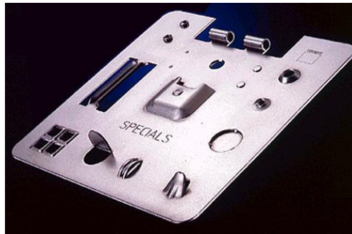
FIGURA 3.81 Varias partes de lámina producidas en una prensa de torreta, mostrando la variedad de formas posibles de agujeros (cortesía de Strippet, Inc.).
