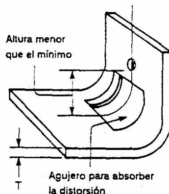
FIGURA. 3.94 Método para evitar la distorsión de agujeros ubicados junto a un doblé.
