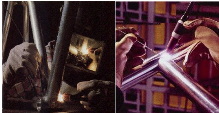
Figura 4.18 b) El Gas "El escudo protector". El escudo de gas que expulsa la antorcha es muy importante para asegurar soldaduras de calidad. La forma de todas las partes internas y externas de la boquilla han sido creadas para lograr las características apropiadas del flujo de gas.
