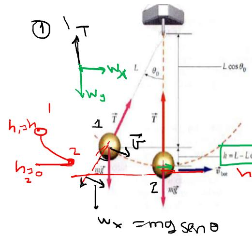
3. Un péndulo consiste en una masa  $m$  conectada a una cuerda de longitud  $L$ . La masa se desplaza de modo que la cuerda forma un ángulo de  $\theta_0$  con la vertical, y luego se libera la masa describe un semicírculo. Encuentre la expresión para la velocidad y la tensión de la cuerda cuando la masa pasa por la parte inferior.
